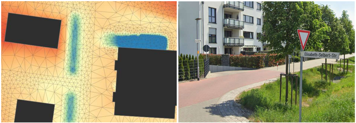
Abbildung 11: Links unstrukturiertes 3D-Berechnungsgitternetz und rechts ein Foto der örtlichen Situation am Ende des Kurt-Oeser-Wegs mit Darstellung des Retentionsgrabens und der Tiefgaragenzufahrt.
