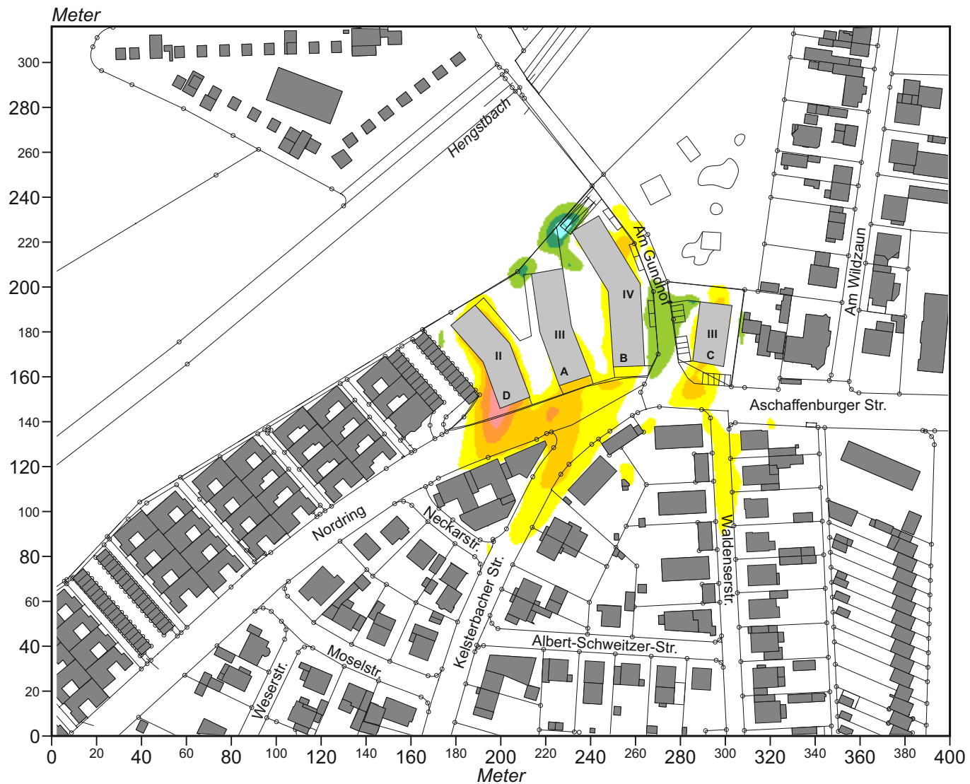
Abb. 16.2 Planungsvariante 2, Ergebnisse mikroskaliger Strömungssimulationen Veränderung der Windgeschwindigkeit gegenüber dem Ist-Zustand 2 m ü.G. bei einer Anströmung aus Nordnordosten (20°) mit 1.5 m/s in einer Höhe von 20 m ü.G.
