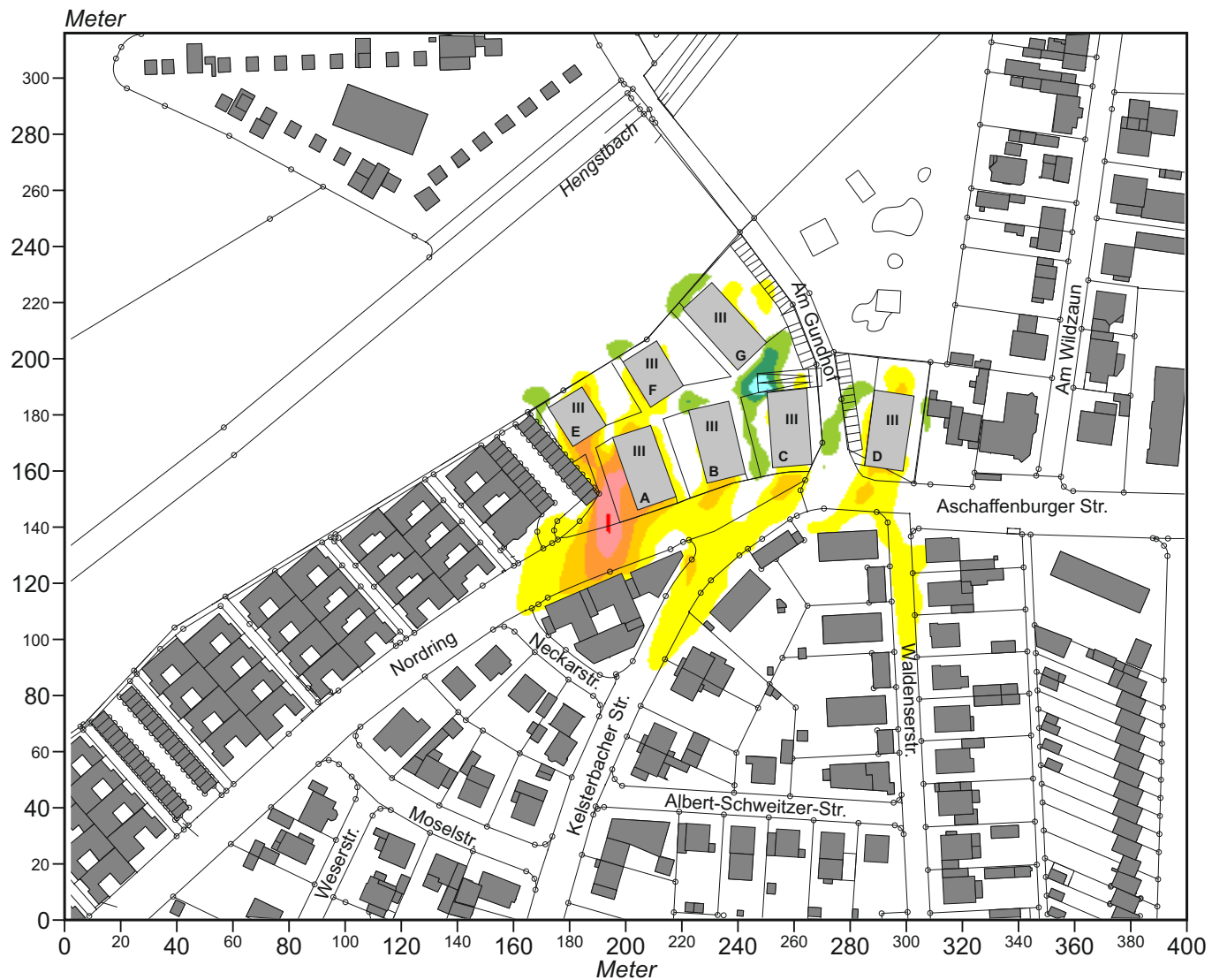
Abb. 15.2 Planungsvariante 1, Ergebnisse mikroskaliger Strömungssimulationen Veränderung der Windgeschwindigkeit gegenüber dem Ist-Zustand 2 m ü.G. bei einer Anströmung aus Nordnordosten (20°) mit 1.5 m/s in einer Höhe von 20 m ü.G.
