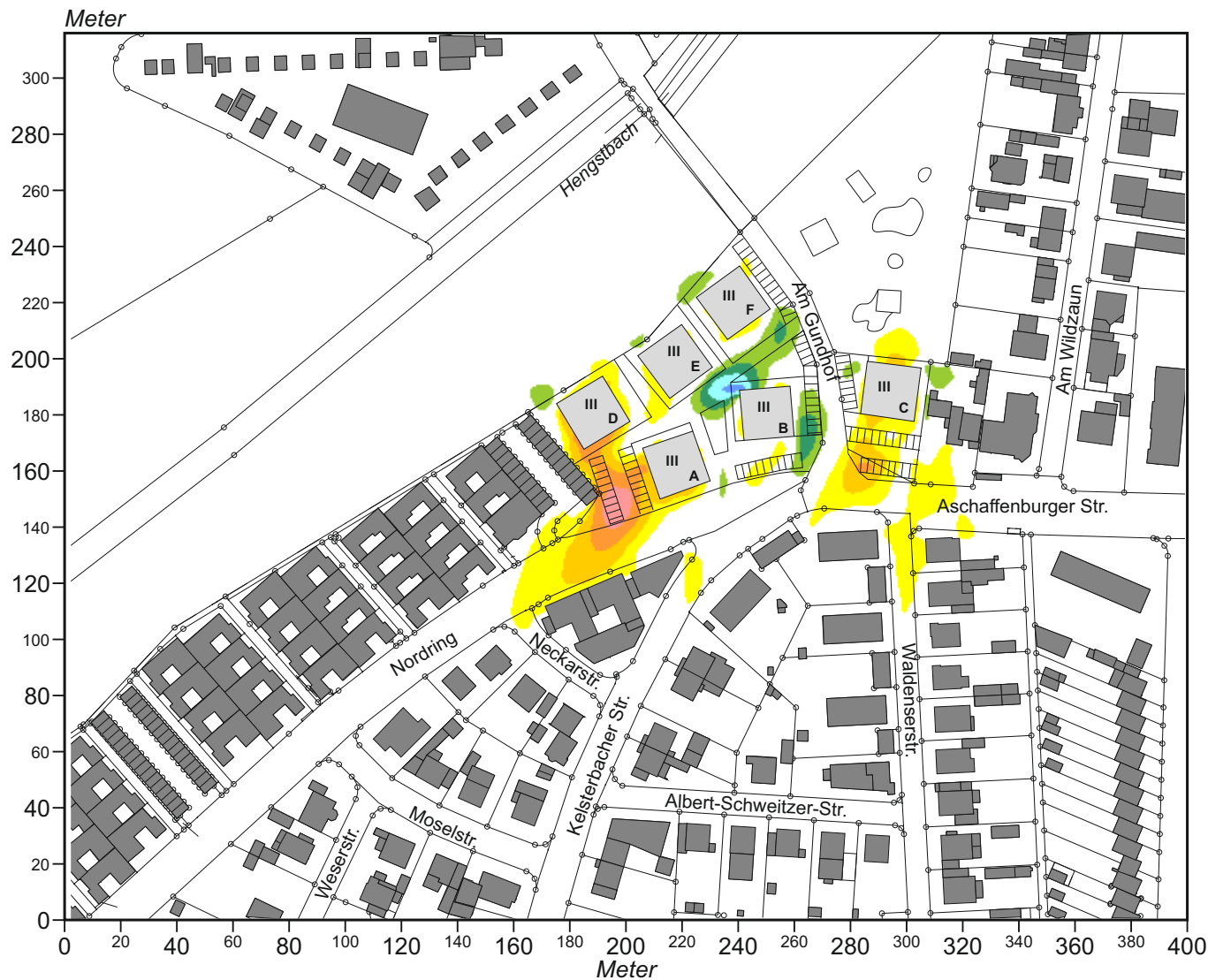
Abb. 17.2 Planungsvariante 3, Ergebnisse mikroskaliger Strömungssimulationen Veränderung der Windgeschwindigkeit gegenüber dem Ist-Zustand 2 m ü.G. bei einer Anströmung aus Nordnordosten (20°) mit 1.5 m/s in einer Höhe von 20 m ü.G.
