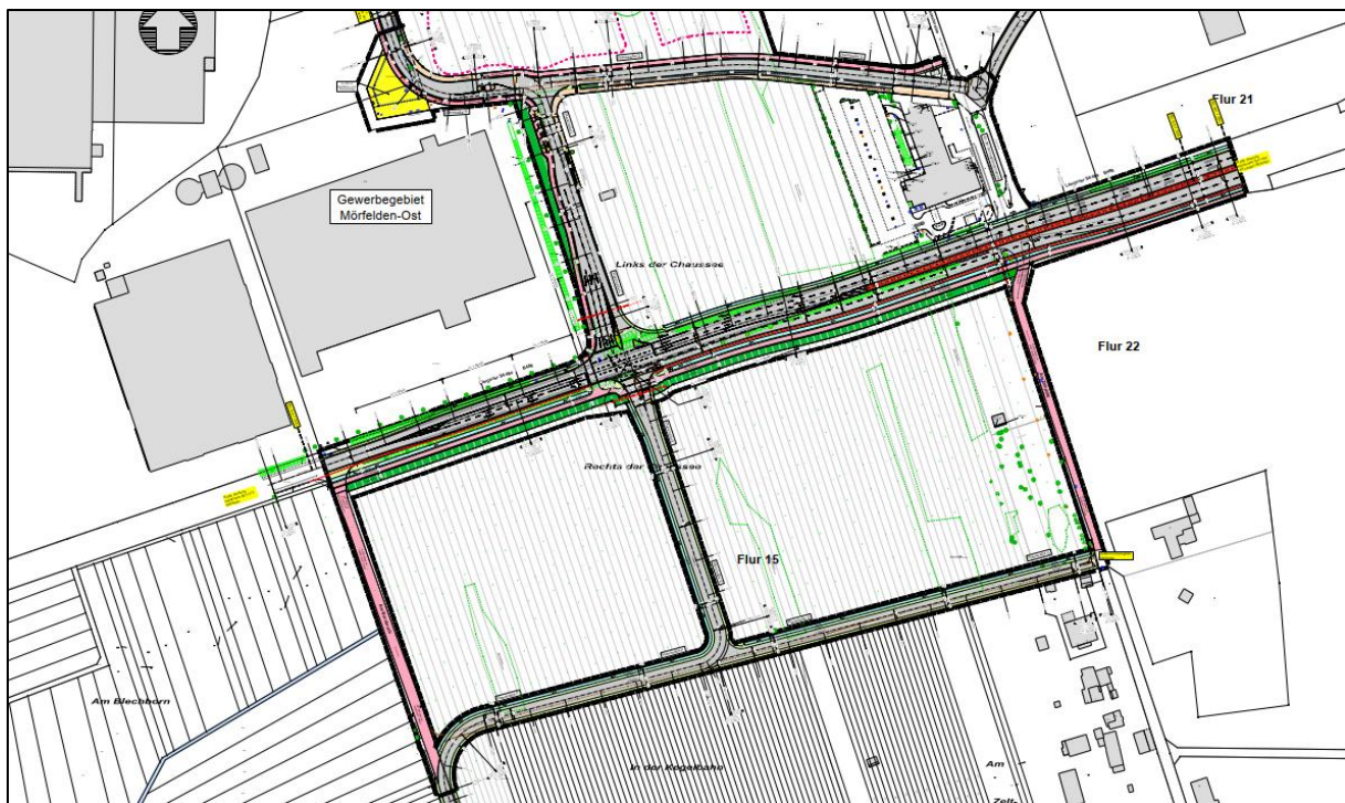
Abb. 24: Entwurfsplanung – Ausschnitt neuer Anschluss an die B486 und veränderte Verkehrsführung Quelle: IGW Idstein GmbH, Mai 2026
