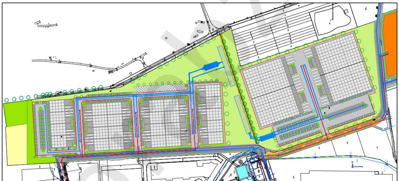
Abbildung 16: Entwässerungskonzept Fläche 1 ( Plan-Nr. W 1.1 ohne Beschriftung)
