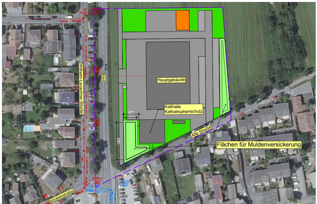
Abbildung 2: Lageplan Feuerwehr und Flächen Muldenversickerung
