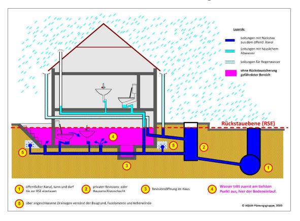
Bei hoher Auslastung des öffentlichen Kanals steigt der Wasserspiegel im Kanalrohr bis über die Höhe des Kellerfußbodens. Wenn es jetzt ungesicherte Abläufe oder undichte Stellen in den Rohren gibt, tritt das Wasser in großen Mengen im Keller aus. Wir haben ausgebaute Keller gesehen, bei denen das Abwasser bis 10 cm unter der Kellerdecke stand.
