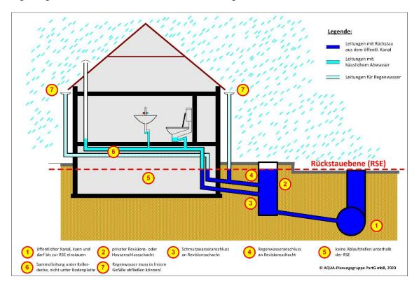
Für Gebäude ohne Keller stellt diese Situation in den meisten Fällen den Normalfall dar. Ein Rückstauschutz wird bei diesen Gebäuden erst dann erforderlich, wenn der Erdgeschossfußboden unterhalb der Rückstauebene liegt.
