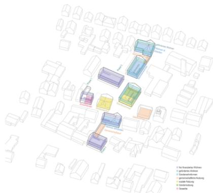
Diagramm Nutzungen & Bauabschnitte: Vielfältige Wohnformen können in Kombination mit Gewerbe und sozialen Nutzungen realisiert werden. Die eindeutige städtebauliche Setzung ermöglicht die Umsetzung in mehreren Bauabschnitten.
